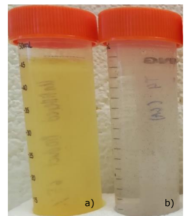
Abbildung 2: Unfiltriertes (a) vs. filtriertes (b) Hard Seltzer, filtriert mit einer CARBOFIL™ CA Filterschicht.
