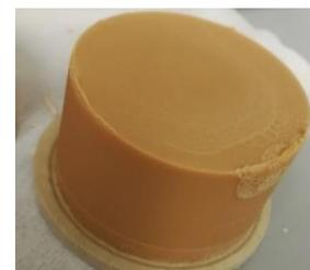
**Abbildung 4: Filterkuchen aus Test Nr. 8.1.** Der Kuchen besteht aus Zellen sowie DE-Partikel.
